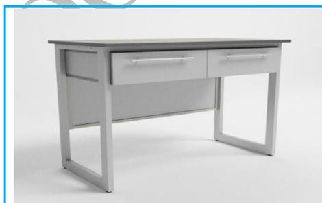
Основание: сварной каркас, выполненный из стального профиля, окрашенного порошковой краской с фактурой шагреновой кожи. Регулируемые по высоте опоры. Задняя рама зашита металлическим листом. Конструкция стола позволяет выдерживать большие нагрузки (в случае установления лабораторного оборудования). Под столешницей расположен короб с двумя выдвижными ящиками. Короб и корпуса ящиков изготовлены из ЛДСП 18мм (цвет алюминий), кромка - АВС 2мм. Релинговые ручки. Ящики - на роликовых направляющих.
