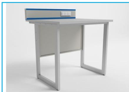
Основание: сварной каркас, выполненный из стального профиля, окрашенного порошковой краской с фактурой шагреновой кожи. Регулируемые по высоте опоры. Задняя рама защищена металлическим листом. Конструкция стола позволяет выдерживать большие нагрузки (в случае установления лабораторного оборудования). Стол укомплектован сервисной панелью с 2 электроблоками из 2 розеток. Столешница на выбор: Trespa TOP LAB (TR), Trespa Athlon (TR-a), керамическая плитка (G), ЛДСП (LA).
